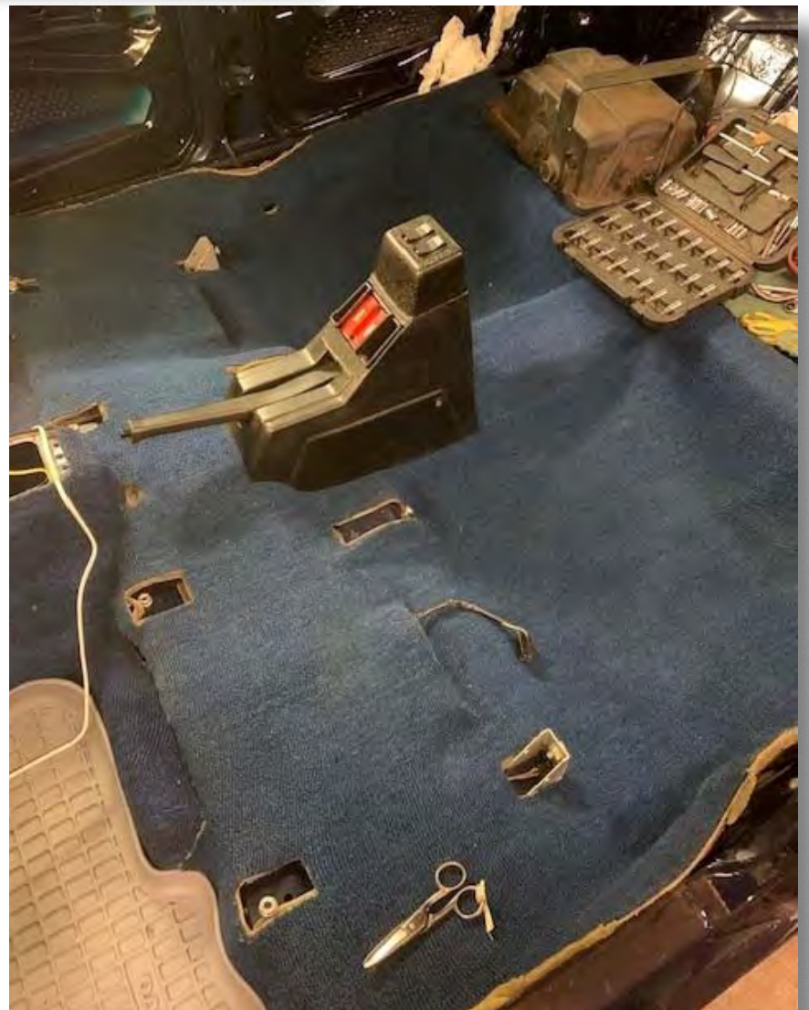
Inredning, montering av golvmattor:
